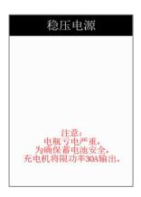
备注: 1.在使用该模式前请确认汽车引擎关闭,或者蓄电池电压低于 14V。
